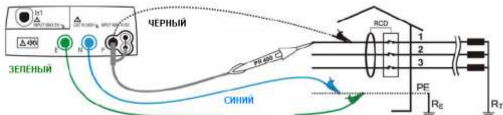
Рис.14: Подключение прибора для проверки УЗО в 3 пр трехфазной сети 400В + PE (нет N) при помощи отдельных измерительных проводов или опционального щупа-пробника
