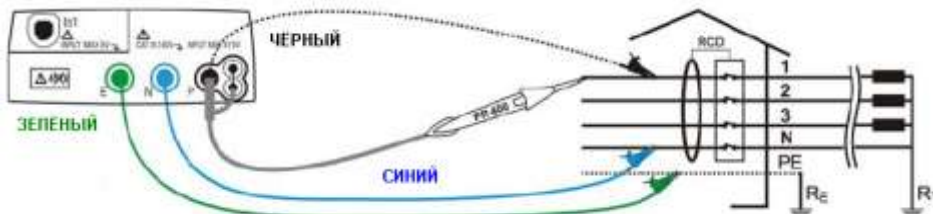
Рис.22: Подключение прибора для измерения полного сопротивления петли P-PE в трехфазной сети 400В + N + PE при помощи измерительных проводов или опционального щупа-пробника
