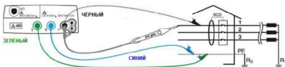
Рис.23: Подключение прибора для измерения полного сопротивления петли P-PE в трехфазной сети 400В + PE (no N) при помощи измерительных проводов или опционального щупа-пробника
